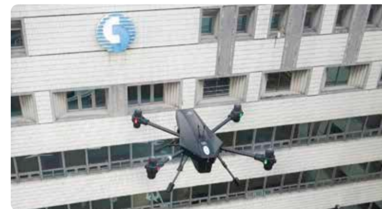
中華電信智慧(空中)無人機巡檢具備AI辨識核心技術並與無人機廠商共同合作取代傳統人工檢查作業
