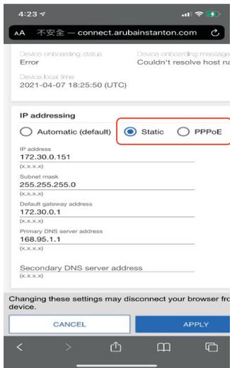
5. 設定完畢後，設備會重新開機。請將 Aruba InstantON 產品接上電信業者的數據機 (Modem)，網路線請接在 Aruba InstantOn E0/PT 位置。
